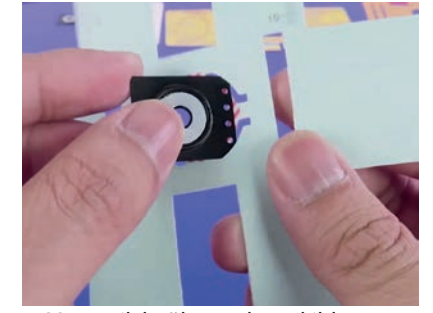
4. Manyetik bağlantıyı bu şekilde köşelerden yerleştirin.
